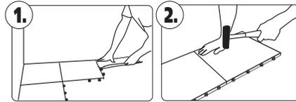
**SE: Underlag:** För god funktion, installera alltid ditt golv på en ren, hård och jämn yta, t ex betong, asfalt, trädäck, hårt komprimerad sand/stenmjöl med markduk. Skydda gärna ett trädäck med markduk.
