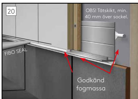
20 För att monteringen ska vara godkänd och garanti ska gälla måste alltid godkänd fogmassa, Fibo Seal, användas. Se bild för hur fogmassa ska påföras.
