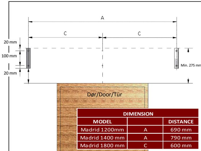
**DK:** Opmål først center punktet af området hvor udhænget skal hænge. Derefter mål min. 275 mm op. Hvor fra en vandret linje opmærkes i længden A eller C. Se ud fra skemaet. Placer derefter knægten(P07) med den vandrette linje til overkant knægt, samt den lodrette linje centret i knægtes huller.(for at sikre en helt lodret knægt kan en lodstok holdes på siden). Marker derefter hullerne i knægten med en tusch.
