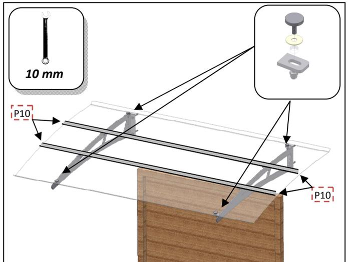
**DK:** Vend derefter polycarbonat pladen. VIGTIGT: Efter montering af gummilister(P06) og aluminiumslister(P03), bor med  $\varnothing 2,5$ mm bor i de for borede huller, MEN kun i gummilisten(P06) og polycarbonat-pladen(P01). IKKE I ALUMINIUMS-LISTEN. Bor KUN 5 mm ned (IKKE HELT IGENNEM). Derefter monteres de små medfølgende skruer(P02).
