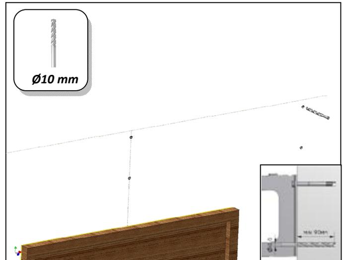
**DK:** Bor derefter hullerne op med et Ø10 mm mur bor, til medfølgende ekspansions bolte (P05). Min. 90 mm. Boltene til fastgørelse kan kun bruges til beton og massive murstens vægge. Hvis udhænget skal hænges op på andet underlag skal andet befæstigelse anskaffes.
